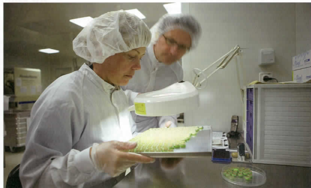
Nach dem Spritzgießen und der automatisierten Montage erfolgt gerade im Bereich der Medizintechnik oft noch eine visuelle Inspektion
